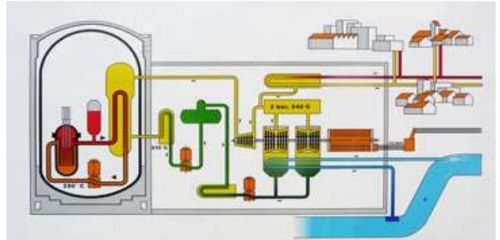
In den zwei Dampfgeneratoren wird die Hitze in einen zweiten Kreislauf eingeführt, dort wird das Wasser komplett vom ersten Kreislauf separiert und gelangt in einen drucklosen Heizkessel. Hier betreibt der erzeugte Dampf, mit Hilfe von Turbinen, die Generatoren.
